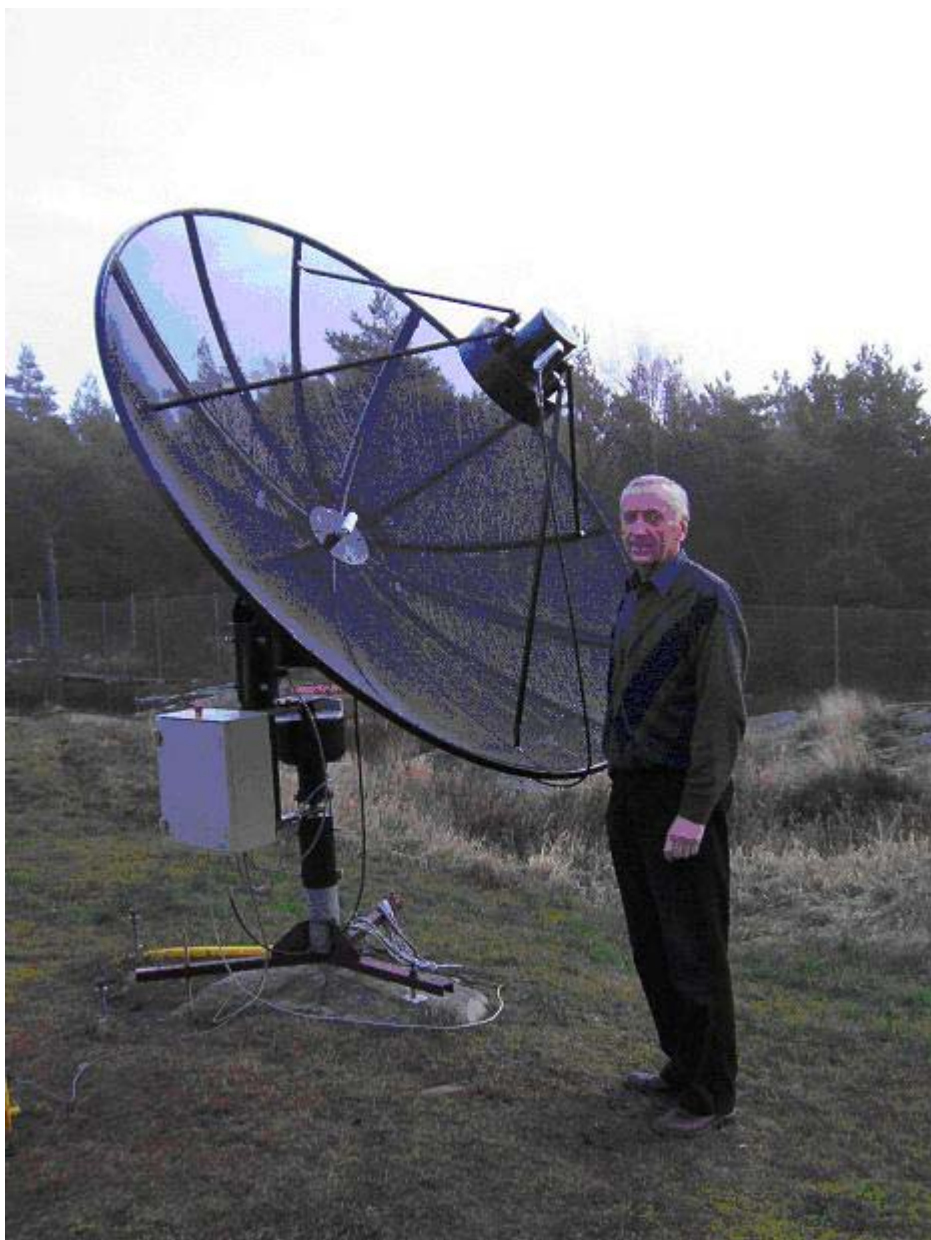
Radioteleskop o średnicy 2,3 m i obsługujący go inżynier
