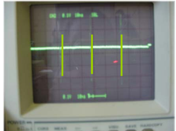
skala ms: impulsy otrzymane w wyniku przejścia nadajnika przed odbiornikiem
